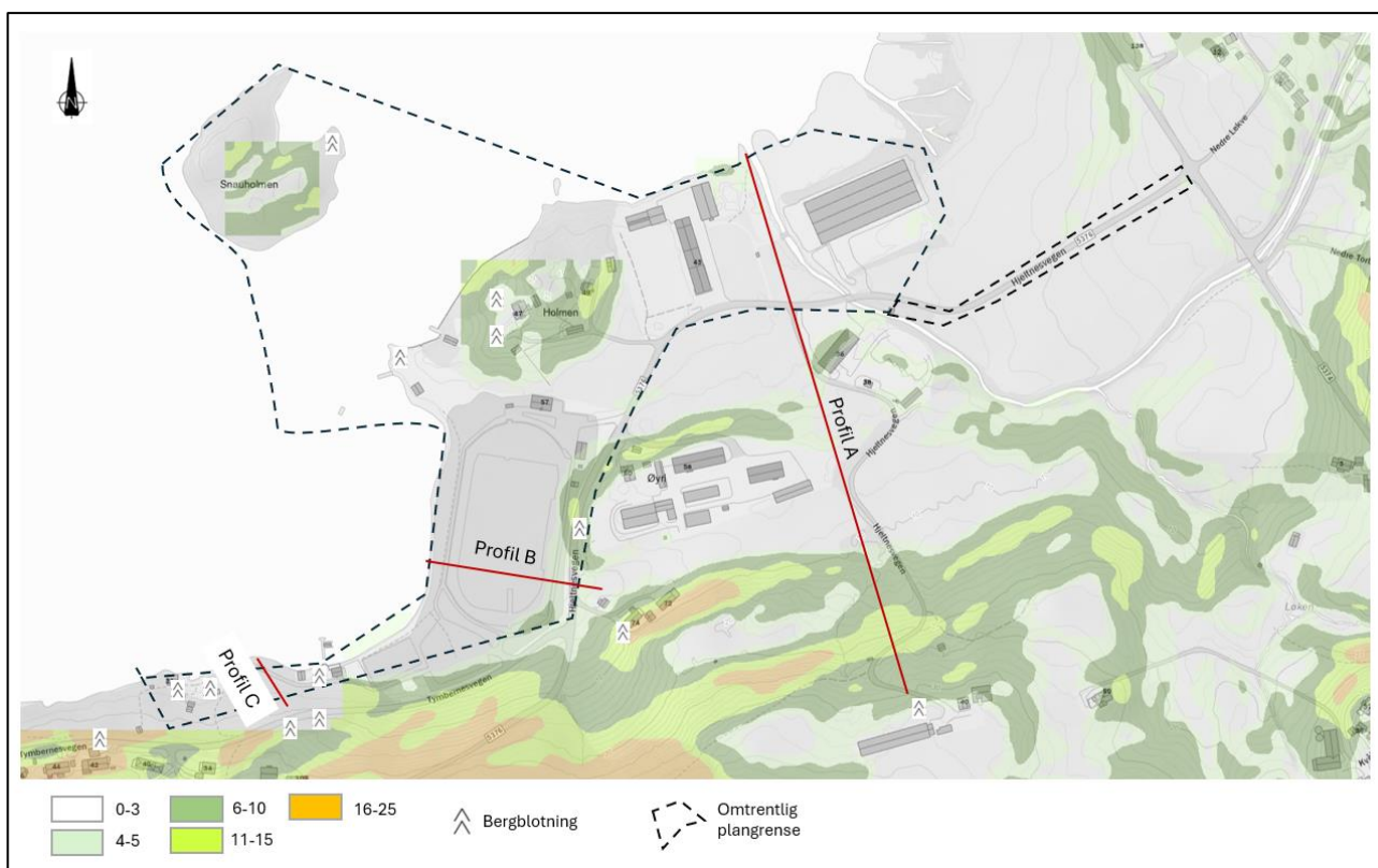
Figur 5-8: Kritiske profil for området med hellingskart som bakgrunn. Hellinga er gitt i grader og 0-3 grader svarar til 1:20.
