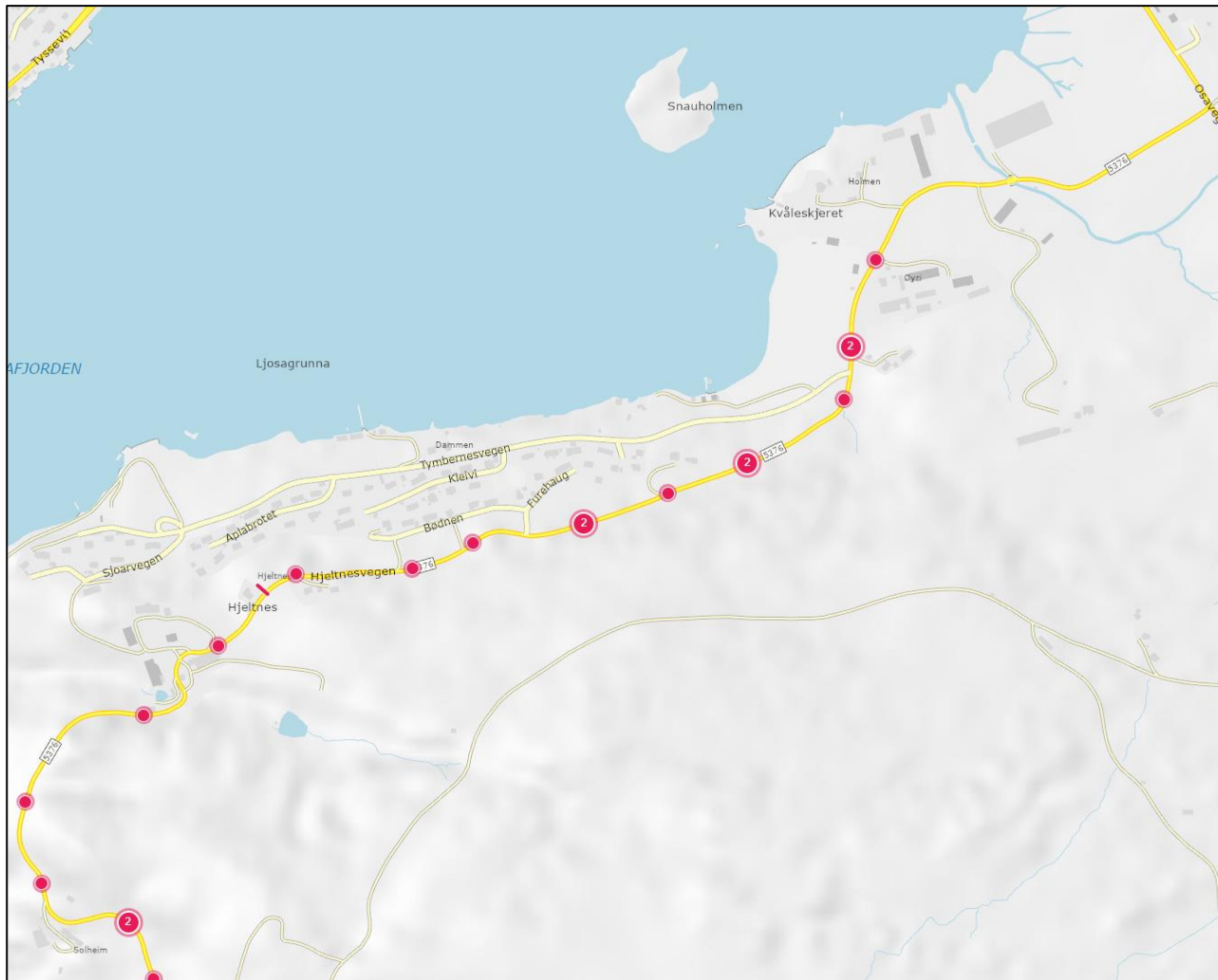
Figur 7-11. Registrerte stikkrenner i Statens Vegvesens vegkart er markert i rødt. (hentet fra vegkart.atlas.vegvesen.no )
