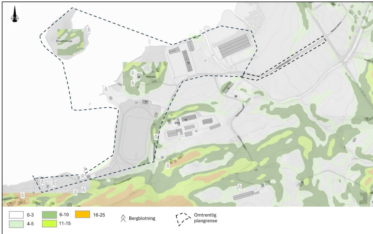
Figur 5-6 Utklipp fra NVE-atlas som viser helling på terrenget i grader [3].
